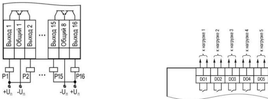
Рисунок 1.13 — Схемы подключения к дискретным выходам
