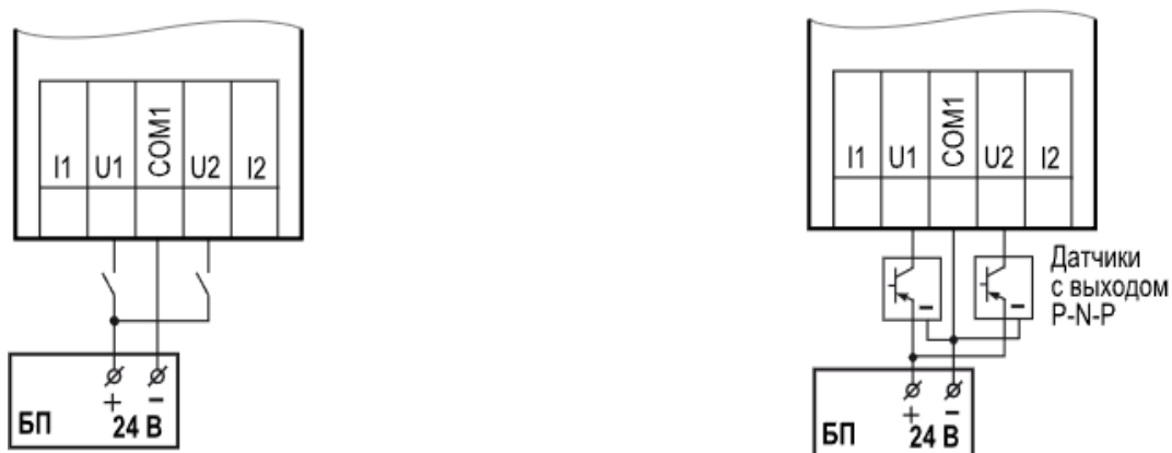
Рисунок 1.4 — Схема подключения к аналоговым входам в дискретном режиме
