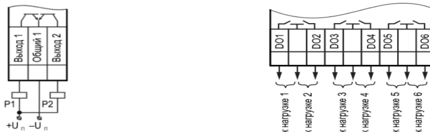
Рисунок 1.6 — Схемы подключения к дискретным выходам
