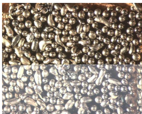
Рис.2. Внешний вид и морфология поверхности гранул, полученных на установке Пульсар СС7
