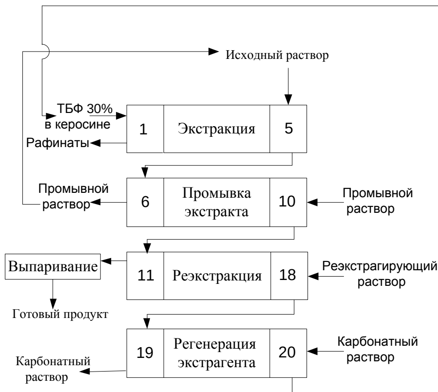
Рис. 1 - Принципиальная схема экстракционной переработки урановых растворов
