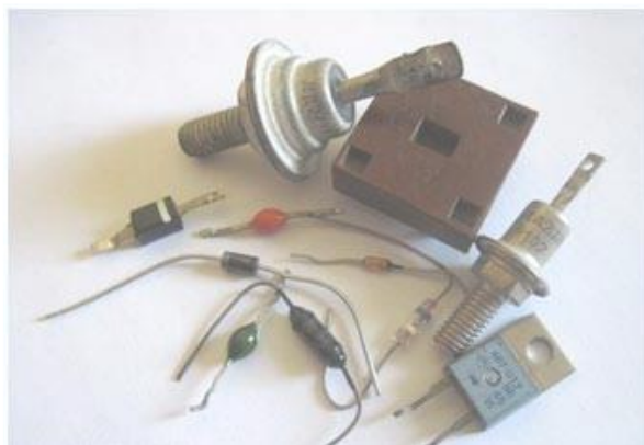
Рисунок 4.7 — Внешний вид выпрямительных диодов
