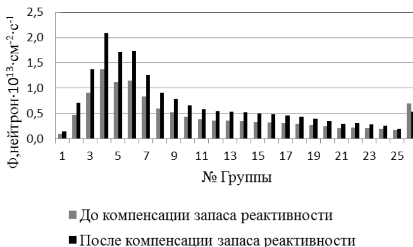
Рисунок 1 – Изменение спектра плотности потока нейтронов ЯР после компенсации запаса реактивности.
