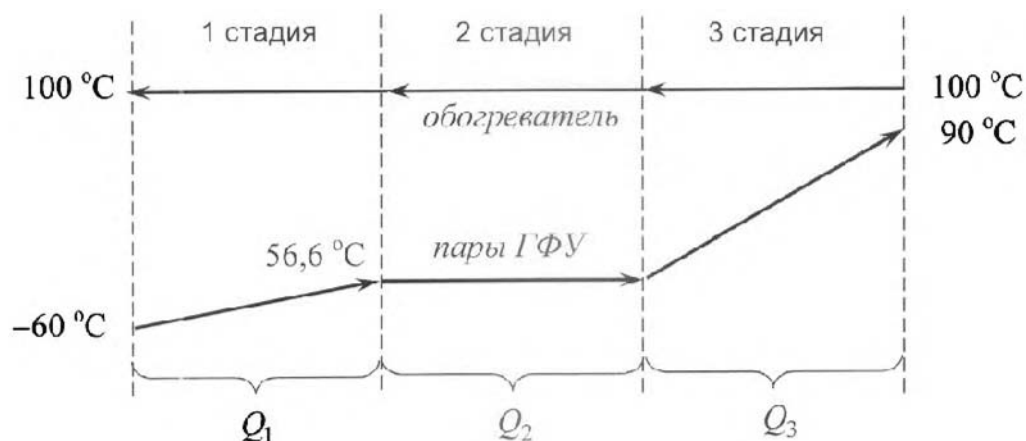
Рисунок 4.10 – Изменение температуры потоков при сублимации ГФУ
